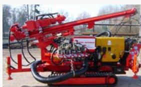
Appareil de forage sur chenille hydraulique fabriqué dans les ateliers du Groupe
